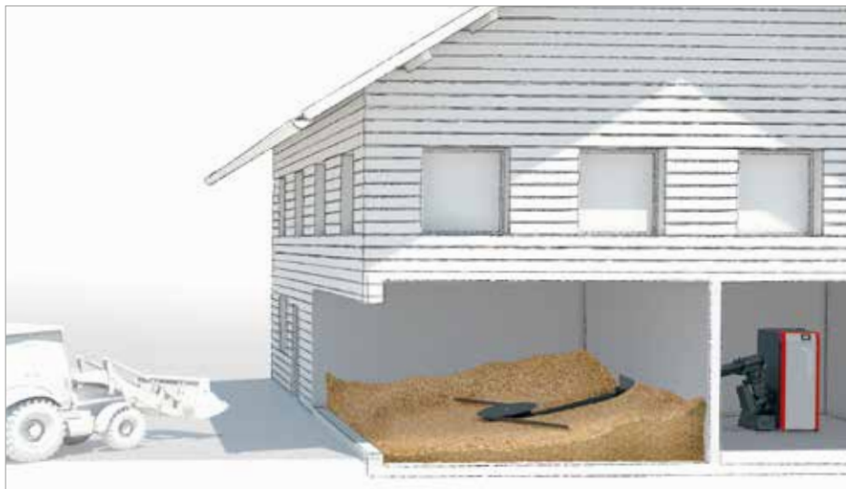
Direkte Befüllung des Lagers, Transport über Schnecke zum Kessel
