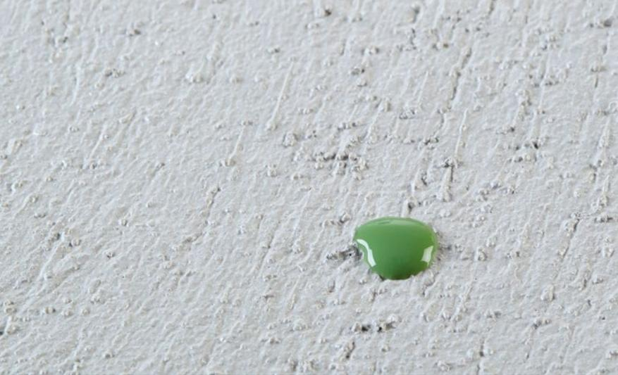
**Grüner Wassertropfen als Kapillarindikator:** Hier sehen Sie den strasser Zementfeinestrich BASE ZFE-W wasserundurchlässig im abgeriebenen Zustand. Gerade einmal 72 Stunden nach dessen Einbau wurde ein Tropfen eingefärbtes Wasser auf die Oberfläche gegeben. Dieser dringt nicht in den Estrich ein.
