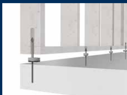
Klebsan® application construction à ossature bois
