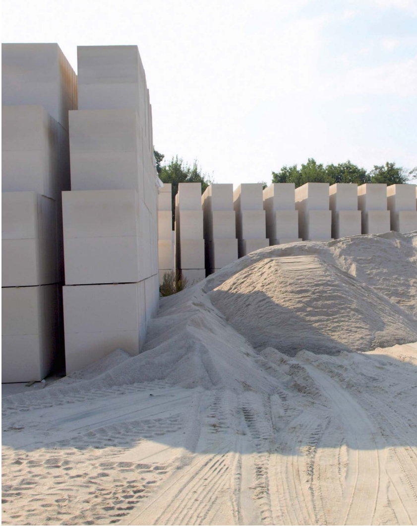
Das Stützskelett des Kalksandsteins bildet der natürlich vorkommende Rohstoff Sand. Foto: Stefan Schöning
