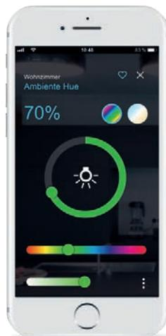
Bedienung einer Leuchte für: EIN/AUS, Dimmen, Einstellen der Farbe sowie der Farbtemperatur (KNX, DALI oder Hue)
