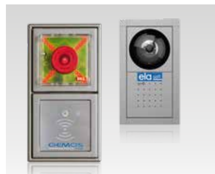
Links: Busleser mit Fluchttürterminal; rechts: Venenscanner
