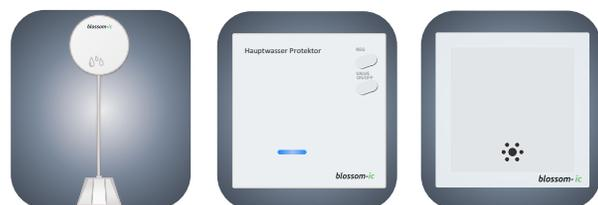
Die Leckagesensoren werden in der Nähe von potentiellen Gefahrenstellen platziert. Nach einer Meldung der Leckagesensoren über einen Wassereinbruch oder einer Leckage, wird die Hauptwasserleitung durch den Hauptwasser Protektor sofort geschlossen. An den Hauptwasser Protektor wird ein handelsüblicher, elektromotorischer Kugelhahn (230 V) angeschlossen. Im Falle eines Wasserschadens, erhält jedes am Gateway registrierte Smartphone sofort eine Push-Benachrichtigung.
