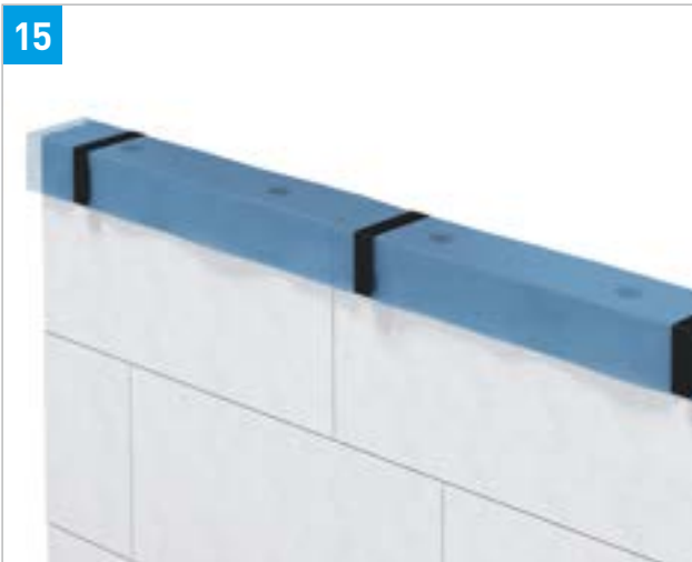
Abdecken der Mauerkrone und Brüstung (Prinzipskizze)
