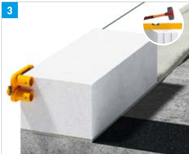
Setzen und Ausrichten der Ausgleichsschicht in Normalmörtel MG III bzw. M10 (Dicke der Mörtelfuge von 1 bis 3 cm)
