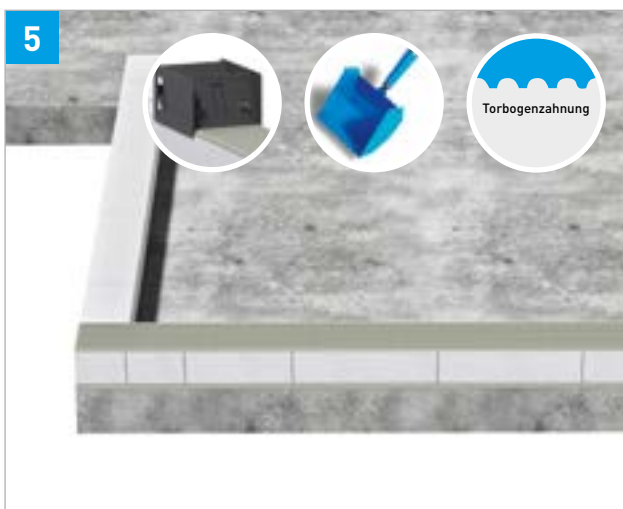
Silka Secure Dünnbettmörtel auftragen
