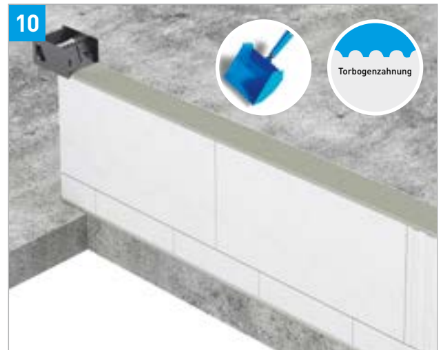
10 Silka Secure Dünnbettmörtel vollflächig auftragen
