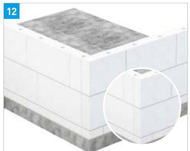
12 Ausführung Stumpfstoßtechnik Edelstahl-Flachanker gemäß Statik einlegen. Breite der Stumpfstoßfuge 1 bis 3 mm Dünnbettmörtel oder bis ca. 2 cm Normalmauermörtel.
