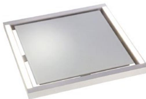
Leuchte mit wärmebeständiger Verdrahtung, Lichtleistung 20 Watt LED, Lichtfarbe 4000 K neutral weiß, Farbwiedergabeindex Ra 90, LED-Gesamtlichtstrom, ca. 2600 lm, Schutzart der Leuchte IP20
