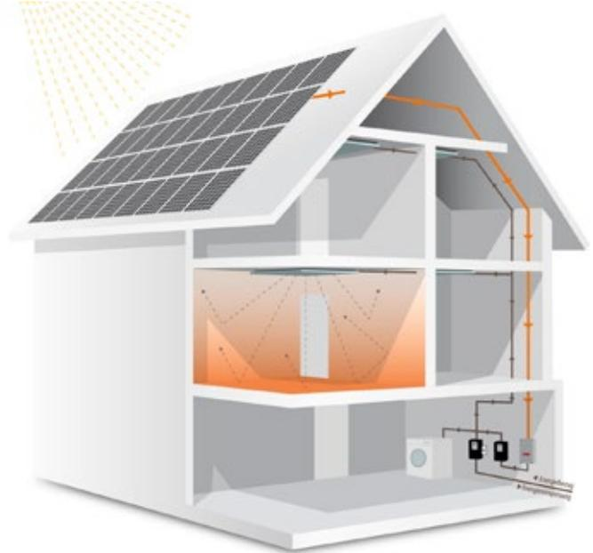
Moderne Gebäudekonzepte binden die Vitramo-Infrartheizung im Verbund mit einer kontrollierten Wohnraumlüftung und Wärmerückgewinnung, PV-Anlage und Batteriespeicher energetisch so ein, dass der Strom optimal genutzt werden kann und der gemittelte Strompreis aus bezogener und erzeugter kWh dauerhaft niedrig bleibt.
