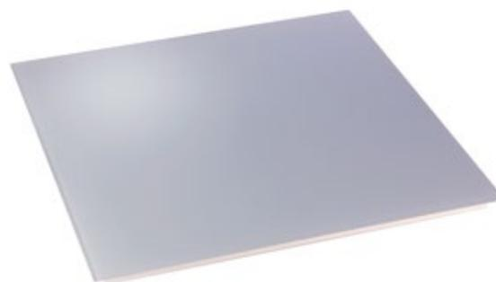
Bei Heizelementen der Baureihe VH hört das Heizmedium 35 mm vor dem Rand der Glasscheibe auf. Da das Glas in diesem Bereich nicht direkt erhitzt wird und Glas ein schlechter Wärmeleiter ist, fällt die Oberflächentemperatur so schnell ab, dass das U-Profil der Systemdecke auf dem das Heizelement aufliegt, nicht mehr als 60 Kelvin über die Umgebungstemperatur erwärmt wird.
