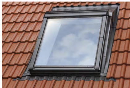
VELUX Aufkeilrahmen Zum Einbau einzelner Fenster 10° steiler als das Dach. Auch als Kombi-Aufkeilrahmen zum Einbau von bis zu 3 Fenstern nebeneinander lieferbar.
