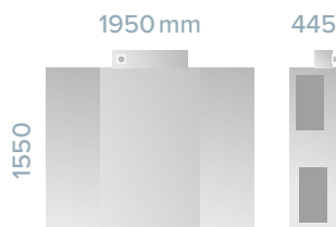
VARIO 1700 CC Gewicht: 259 kg Einsatz: Stand- und Deckengerät
