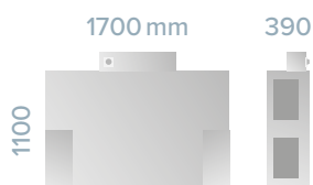
VARIO 1100 CC Gewicht: 169 kg Einsatz: Stand- und Deckengerät
