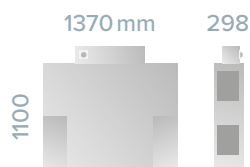
VARIO 660 CC Gewicht: 115 kg Einsatz: Stand- und Deckengerät
