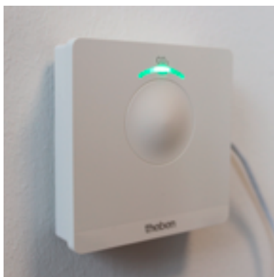
LED-Ampelsystem beim AMUN 716 CO 2 Monitor
