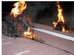
Typischer Dachaufbau mit Bitumenbahnen und Brandversuch
