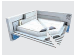
Typischer Dachaufbau mit Kunststoffbahnen und Brandversuch
