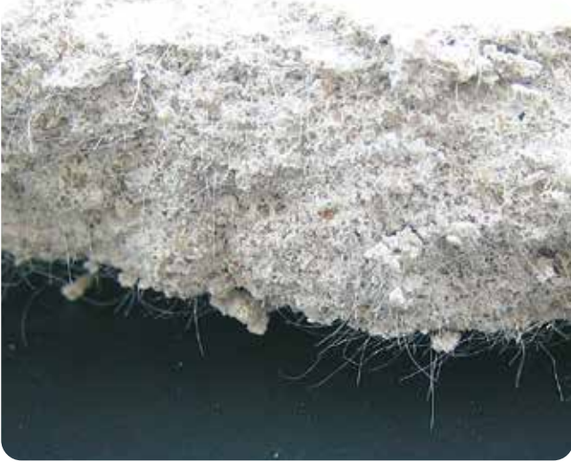
Fasern erhöhen die Zugfestigkeit von Putzen
