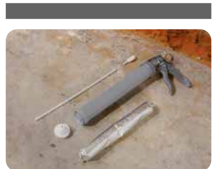
6. Das Einbringen der Injektionscreme weber.tec 946 erfolgt drucklos mittels weber.sys Handdruckspritze Nr. 3 und zugehörigem Injektionsröhrchen. Alternativ kann zur rationellen Materialförderung das Einbringen der Creme mit geeigneten Drucksprühgeräten, z.B. Gloria, erfolgen
