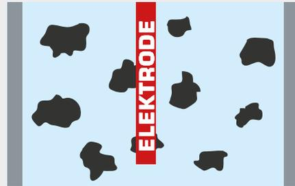
**02** Durch eine Hochspannungselektrode werden Elektronen freigesetzt.
