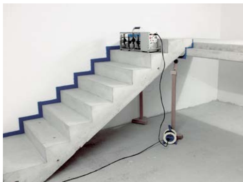
Realitätsnaher Prüfaufbau nach DIN 7396
