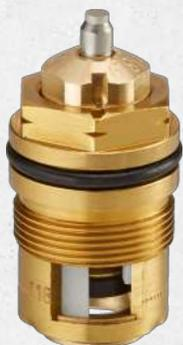
Die Ventileinsätze sind für den Ersatz in Thermostatventilen geeignet. Zur Anpassung an die Anlagenanforderungen und zum manuellen bzw. auch automatischen hydraulischen Abgleich sind die Ventileinsätze voreinstellbar. Die Ventileinsätze sind passend für alle Thermostatventile, so kann man jederzeit ohne Austauschen des gesamten Ventils von den Vorteilen der verschiedenen Ventileinsätze profitieren.
