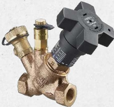
Für den hydraulischen Abgleich von Verteilungen in Zentralheizungs- und Kühlanlagen mit geschlossenen Kreisläufen. Varianten mit Messventilen erlauben eine Durchflussbestimmung durch Differenzdruckmessung mit dem Messsystem OV-DMC 3 unter Berücksichtigung der Voreinstellwerte. In Schrägsitzausführung mit gesicherter, jederzeit kontrollierbarer, stufenloser Feinstvor-
