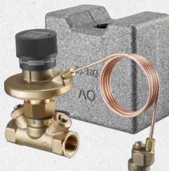
Für den automatischen hydraulischen Abgleich von Verteilungen in Zentralheizungs- und Kühlanlagen mit geschlossenen Kreisläufen. Die Differenzdruckregelung gewährleistet den hydraulischen Abgleich auch im Teillastbereich und verhindert hohe Differenzdrücke im geregelten Anlagenabschnitt, z.B. am Heizkörperventil.
