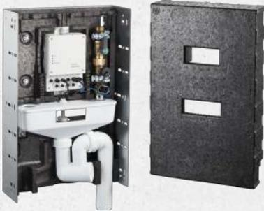
Hygiene - Spülstation zur Absicherung von Kalt- und Warmwassersträngen und zur Aufrechterhaltung des bestimmungsgemäßen Betriebs in Trinkwasserinstallationen, z.B. bei Nutzungsunterbrechungen. Zur Montage am Ende des Stranges oder in Ringinstallationen.
