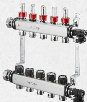
Die **Multidis SF** Heizkreisverteiler aus Edelstahl für Flächenheizung und -kühlung für 2 – 12 Heizkreise sind im Vorlauf mit integrierten Reguliereinsätzen bzw. mit integrierten Durchfluss-, Mess- und Reguliereinsätzen ausgerüstet. Im Rücklauf sind Ventileinsätze mit einem Anschlussgewinde M 30 x 1,5 integriert, um optional Stellantriebe anzuschließen. Die Heizkreisverteiler sind komplett vormontiert mit
