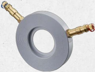
Messblenden PN 16 / PN 25 mit Gewinden oder in Zwischenflanschausführung. Standardmäßig mit Classic Messventilen ausgestattet. Zur Durchflussbestimmung in Zentralheizungs- und Kühlanlagen. Die Durchflussbestimmung erfolgt durch Differenzdruckmessung über die Messblende. Veränderung der
