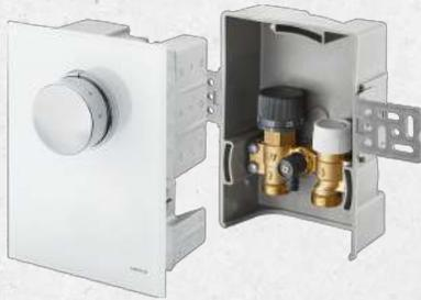
Die **Unibox** Raum- und Rücklauftemperaturregelung dient zur Flächentemperierung von Räumen mit einer Größe von bis zu 20 m<sup>2</sup>, wie z.B. dem Badezimmer. Besonders eignen sich die **Uniboxen** zur Nachrüstung einer Flächentemperierung in Heizungsanlagen im kombinierten Einsatz mit Radiatoren. Außerdem wird die **Unibox** auch zur Einzelraumtemperaturregelung verwendet. Die **Unibox** besteht aus dem Wandeinbaukasten mit vor-einstellbarem Thermostatventil, dem integrier-
