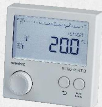
Die R-Tronic Funkthermostate mit geschlossener Funkkommunikation (herstellereigen) werden im Stand-alone Betrieb in Verbindung mit Funkstellantrieben zur Regelung von Heizkörpern oder in Verbindung mit einem Mehrkanalfunkempfänger zur Regelung von Flächenheizungen eingesetzt.
