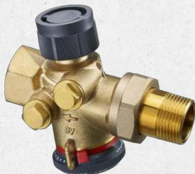
Druckunabhängiges Regelventil für den dynamischen hydraulischen Abgleich von Wärmetauschern, zum Beispiel Gebläsekonvektoren oder Kühldecken und Verteilleitungen in Heizungs- und Kühlanlagen mit geschlossenen Kreisläufen. Die Ventilkombination besteht aus einem automatisch arbeitenden Mengenregler und einem Regelventil und kann mit einem Stellantrieb oder einem Handregulierkopf ausgestattet werden.
