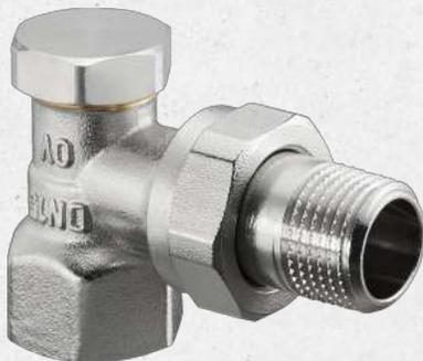
Die Combi 2 Rücklaufverschraubungen sind für die untere Anbindung der Rohrleitung an Heizkörper mit konventionellem Ventilanschluss geeignet. Die Verschraubungen verfügen über eine proportionale Voreinstellung
