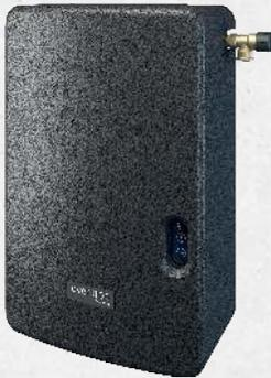
Die Regumaq X-25 Frischwasserstation ist eine elektronisch geregelte Armaturengruppe mit Wärmeübertrager zur hygienischen Trinkwassererwärmung nach dem Durchlaufprinzip zum Anschluss an einen Pufferspeicher. Abhängig von der Temperatur und dem Volumenstrom auf der Trinkwasserseite wird die Umwälzpumpe auf der Heizungseite drehzahl-geregelt. Bei der Auswahl der Frischwasserstation ist es notwendig die Wasserqualität des Einsatzgebietes zu beachten.
