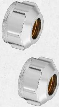
Ofix Klemmringverschraubungen für G  $\frac{3}{4}$  AG und G  $\frac{3}{8}$ , G  $\frac{1}{2}$  und G  $\frac{3}{4}$  IG sind für verschiedene Rohrarten, wie Kupferrohre, Kunststoffrohre, Edelstahlrohre, Präzisionsstahlrohre und verzinkte Stahlrohre verfügbar. Zudem sind metallisch- sowie weichdichtende Varianten erhältlich. Bei der weichdichtenden Variante sind keine Stützhülsen nötig.
