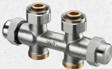
Die Multiflex FQ Anschlussarmaturen sind für die Anbindung von Heizkörpern mit integrierter Ventilgarnitur konzipiert. Durch den speziellen QA-Ventileinsatz ist die Armatur für den automatischen hydraulischen Abgleich am Heizkörper in Zentralheizungs- und Kühlanlagen mit geschlossenen Kreisläufen geeignet.
