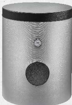
Monovalente Trinkwasserspeicher zur Speicherung von Trinkwasser mit innenliegendem Wärmeübertrager für Nachheizung. Es können Wärmeerzeuger, wie z.B. konventionelle Heizkessel, Wärmepumpen oder Nahwärme angeschlossen werden.
