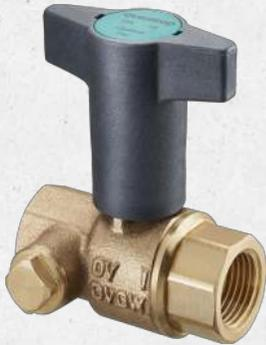
Trinkwasserkugelhahn tottraumfrei, mit vollem Durchgang nach DIN EN 13828 und durchspültem Kugelhinterraum.
