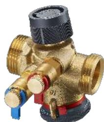
Nennweiten DN 10, DN 25 und DN 32 flachdichtend. Nennweiten DN 15 und DN 20 konisch dichtend, mit Einlegestück 1661100 (für DN 15) bzw. 1650793 (für DN 20) flachdichtend.
