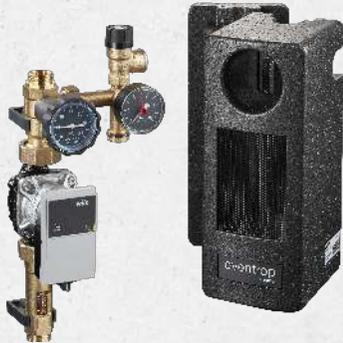
Für die Anbindung eines Solarkreislaufs. Die Pumpenstränge ermöglichen das rücklaufseitige Absperrn des Solarkreislaufs und verhindern über ein integriertes Sperrventil eine Eigenzirkulation bei abgeschalteter Pumpe.
