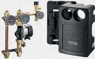
Für die Anbindung eines Solarkreislaufs. Die Stationen ermöglichen das vor- und rücklaufseitige Absperrn des Solarkreislaufs und verhindern über integrierte Sperrventile eine Eigenzirkulation bei abgeschalteter Pumpe.
