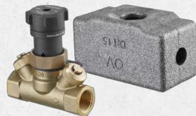
Für die Absperrung von Verteilungen in Zentralheizungs- und Kühlanlagen mit geschlossenen Kreisläufen. Mit Umrüsthendrad zum Strangregulierventil nachrüstbar. Ventil in Geradsitzausführung ohne Voreinstellung. Mess- und Entleerventil als Anschluss für die Impulsleitung eines Differenzdruckreglers. Wärmedämmschalen für Temperaturen bis
