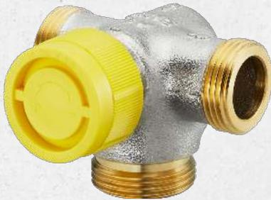
Die Dreiwegeumrüstventile sind geeignet für Einrohrheizungsanlagen mit Zwangsumwälzung und werden oftmals beim Wohnungsbau der neuen Bundesländer verwendet. Das Gehäuse besteht aus vernickeltem Rotguss/Messing, vernickelt. Der Ventileinsatz ist aus Messing, die Spindel und Feder aus nichtrostendem Stahl. Der Ventilteller hat eine Weichdichtung. Die Rohranschlüsse sind mit flachdichtendem Außengewinde, ausgeführt.
