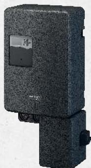
Regudis H Hausübergabestationen mit Plattenwärmeübertrager zur direkten und indirekten Übertragung der Wärme aus einem Nah- oder Fernwärmenetz an das Trinkwasser- und Heizungssystem von Ein- und Zweifamilienhäusern. Die Stationen verfügen über einen elektronischen Regler zur witterungsgeführten Steuerung der Heizungsvorlauftemperatur und zur gleichzeitigen Begrenzung der Rücklauftemperatur zum Wärmenetz.
