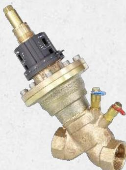
Druckunabhängiges Regelventil für den dynamischen hydraulischen Abgleich von Wärmetauschern, zum Beispiel Gebläsekonvektoren oder Klimageräten, und Verteilleitungen in Heizungs- und Kühlanlagen mit geschlossenen Kreisläufen. Die Ventilkombination, besteht aus einem automatisch arbeitenden Mengenregler und einem Regelventil und kann mit einem Stellantrieb ausgestattet werden. Ventil in Zweibegeausführung, mit gesicherter, plombierbarer, stufenloser Durchflussbe-
