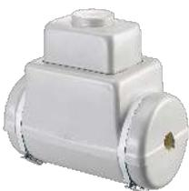
Aus PUR Hartschaum mit PS Schale. Für Heizungs- und Kühlanlagen. Baustoffklasse B2 nach DIN 4102. Entspricht den Anforderungen gemäß Anlage 8 zu §§ 69 und 71 Absatz 1, Zeile ee) des Gebäudeenergiegesetzes (GEG). Kälteisolierung: Medientemperatur min. 6 °C, Wärmedämmschalen luftdicht verkleben. Eingeschränkte Diffusionsdichtheit bei niedrigerer Medien- sowie hoher Umgebungstemperatur und/oder Luftfeuchtigkeit.
