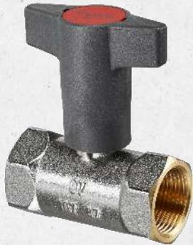
Kugeloberfläche hart verchromt. Verlängerter Knebelgriff aus Kunststoff, anthrazit, für einfaches dämmen. Mit austauschbarer, roter Kappe zur Strangkennzeichnung.
