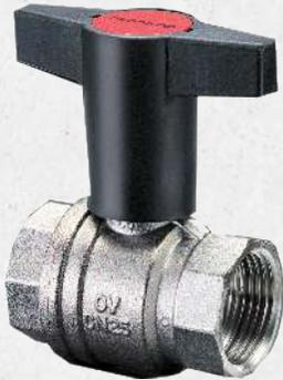
Kugeloberfläche hart verchromt. Verlängerter Knebelgriff aus Kunststoff, anthrazit, für einfaches dämmen. Mit austauschbarer roter Kappe zur Strangkennzeichnung.
