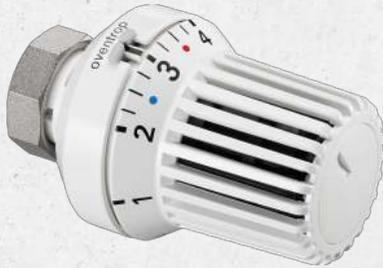
Der **Uni X Thermostat** ist ein designorientierter Heizkörperthermostat. Die Handhabung und die Ablesbarkeit sind optimal aufeinander abgestimmt. Der Heizkörperthermostat ist mit einer Memoscheibe zur Markierung einer gewählten Einstellung ausgestattet, die das Wiedereinstellen einer Wunschtemperatur nach einem Verdrehen des Handgriffes vereinfacht.
