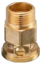
Zur Verhinderung einer Schwerkraftzirkulation in verschiedenen Heizungssystemen bei abgeschalteter Pumpe. Zum direkten Anschluss an die Umwälzpumpe. Öffnungsdruck 20 mbar.
