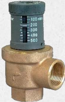
Für Pumpenwarmwasserheizungen PN 10. Mit optischer Anzeige zur Gewährleistung einer Mindestumlaufmenge bzw. zur Verminderung von Fließgeräuschen.
