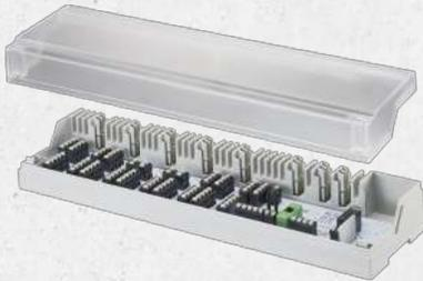
Die Anschlussleiste dient der Verdrahtung von Einzelraumregelungen und wird eingesetzt für die Flächenheizungs- und -kühlungsregelung. Mit der Anschlussleiste kann eine einfache Zuordnung der einzelnen Räume bzw. Heizkreise zentral durchgeführt werden. Es können, je nach Variante, bis zu 10 Zonen für Heiz- und
