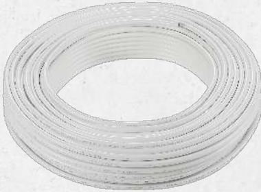
Die Mehrschichtverbundrohre **Copipe HSC** (PE-RT/AL/PE-RT) sind für die Flächenheizung und -kühlung geeignet. Die **Copipe** Rohre bestehen aus 5 Schichten (äußeres Mantelrohr
