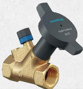
Für die Absperrung von Verteilleitungen in Zentralheizungs- und Kühlanlagen mit geschlossenen Kreisläufen. In Schrägsitzausführung ohne Voreinstellung. Standardmäßig mit einem HydroPort Hilfsventil ausgerüstet, über das auch die Impulsleitung eines HydroControl D Differenzdruckreglers unter Anlagendruck angeschlossen werden kann.
