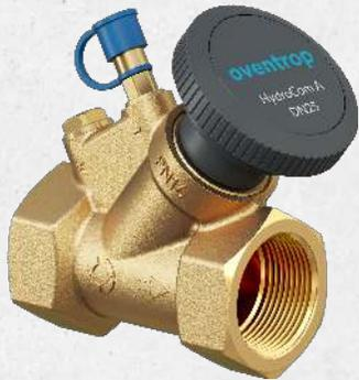
Für die Absperrung von Verteilungen in Zentralheizungs- und Kühlanlagen mit geschlossenen Kreisläufen. Ventil in Schrägsitzausführung ohne Voreinstellung. Ein HydroPort Hilfsventil auf der Abströmseite als Anschluss für die Impulslei-
