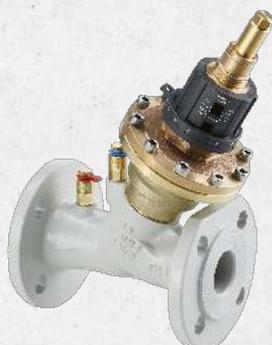
Druckunabhängiges Regelventil für den dynamischen hydraulischen Abgleich von Wärmetauschern, zum Beispiel Klimageräten, und Verteilungen in Heizungs- und Kühlanlagen mit geschlossenen Kreisläufen. Die Ventilkombination, besteht aus einem automatisch arbeitenden Mengenregler und einem Regelventil und kann mit einem Stellantrieb ausgestattet werden.
