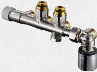
Die Multiblock TQ-RTL Anschlussarmatur ist für den kombinierten Einsatz von Heizkörper und Flächentemperierung in Zweirohranlagen konzipiert. Die Armatur beinhaltet einen QA-Ventileinsatz für den automatischen hydraulischen Abgleich sowie einen RTL-Regler für die Rücklauftemperaturbegrenzung. Die Regelung von Raumtemperatur und Rücklauftemperatur erfolgt getrennt. Die Armatur ist zum Heizkörper weichdichtend. Die Anschlussarmatur ist für den Anschluss an Heizkörpern mit G 1/2 IG geeignet.
