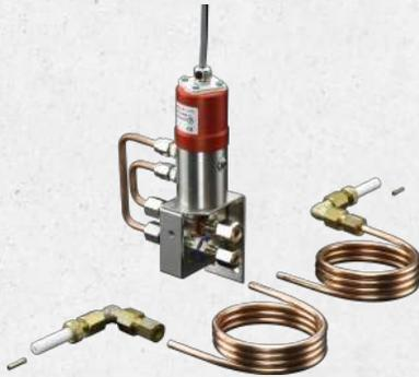
Differenzdruckaufnehmer zur permanenten Differenzdrucküberprüfung an Oventrop-Armaturen mit Classic-Messtechnik in Heizungs- und Kühlanlagen, die mit Wasser oder Wasser-Glykolgemischen betrieben werden. Der Differenzdruck wird über die Messnadeln und die Kupferleitungen an den Messventilen der zu messenden Armatur abgenommen. Im Betrieb liefert der Differenzdruckaufnehmer ein zum gemessenen Differenzdruck proportiona-
