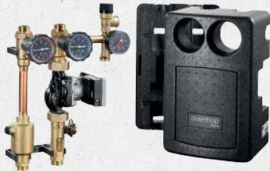
Für die Anbindung eines Solarkreislaufs. Die Stationen ermöglichen das vor- und rücklaufseitige Absperren des Solarkreislaufs und verhindern über integrierte Sperrventile eine Eigenzirkulation bei abgeschalteter Pumpe. Ein Entlüftertopf ermöglicht die Entgasung des Wärmeträgermediums im Vorlaufstrang.
