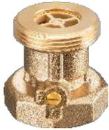
Zur Verhinderung einer Schwerkraftzirkulation in verschiedenen Heizungssystemen bei abgeschalteter Pumpe. Zum Einbau nach der Pumpe. Öffnungsdruck 20 mbar.
