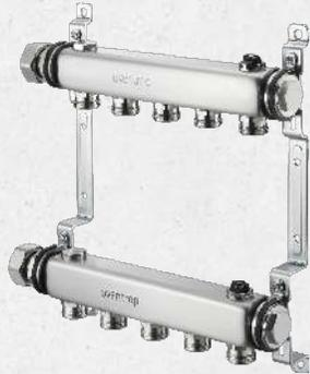
Die **Multidis SH** Heizkreisverteiler aus Edelstahl zur Heizkörperanbindung für 2 - 12 Heizkreise sind mit vernickelter flachdichtender Überwurfmutter mit G 1 Innengewinde ausgerüstet. Die Heizkreisanschlüsse mit G 3/4 Außengewinde sind passend für Oventrop Klemmringverschraubungen. Mit lose bei-
