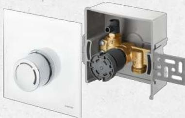
Die **Unibox** Rücklauftemperaturregelung dient zur Flächentemperierung von Räumen mit einer Größe von bis zu 20 m<sup>2</sup>, wie z.B. dem Badezimmer. Besonders eignen sich die Uniboxen zur Nachrüstung einer Flächentemperierung in Heizungsanlagen im kombinierten Einsatz mit Radiatoren. Die **Unibox** besteht aus dem Wandeinbaukasten mit Thermostatventil, dem integrierten Rücklauftemperaturbegrenzer, einem Entlüftungs- und Spül-
