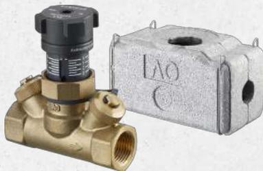
Für den hydraulischen Abgleich von Verteilungen in Zentralheizungs- und Kühlanlagen mit geschlossenen Kreisläufen. Bei den Nennweiten DN 15...25 können die Ventileinsätze ohne Entleeren der Anlage ausgetauscht und für die Aufnahme eines Antriebes, Thermostaten oder Differenzdruckregleroberteils umgerüstet werden. Für den Austausch wird der Demo-Bloc benötigt.
