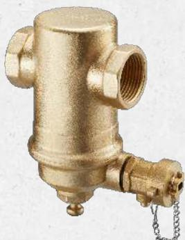
Schlammabscheider entfernen kontinuierlich kleinste Schmutzpartikel, ohne den Durchflusswiderstand wesentlich zu erhöhen. Ein starker Magnet hält Magnetit fest. Beim Herausziehen des Magneten fallen die magnetischen Partikel in den Sumpf und können ohne Betriebsunterbrechung über einen Kugelhahn
