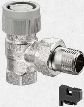
Für den automatischen hydraulischen Abgleich in Heiz- und Kühlsystemen mit geschlossenem Wasserkreislauf. Einbau im Vorlauf. Die Q-Tech Ventile **mit hohem Durchfluss (AQH)** eignen sich ideal für Neubau, Sanierung und zur Nachrüstung in Verbindung mit Deckenstrahlplatten, Fan-Coils, Heizkörpern sowie anderen Verbrauchern. Aufwendige Rohrnetzrechnungen sind nicht erforderlich. Der Volumenstrom wird auch bei schwankendem Differenzdruck in der Anla-
