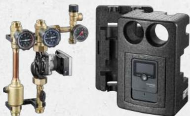
Für die Anbindung eines Solarkreislaufs. Die Stationen ermöglichen das vor- und rücklaufseitige Absperren des Solarkreislaufs und verhindern über integrierte Sperrventile eine Eigenzirkulation bei abgeschalteter Pumpe. Ein Entlüftertopf ermöglicht die Entgasung des Wärmeträgermediums im Vorlaufstrang. Der integrierte elektronische Regler übernimmt die Steuerung und Überwachung der solarthermischen Anlage.
