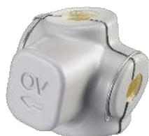
Wärmedämmschale, zweischalig. Entspricht den Anforderungen gemäß Anlage 8 zu §§ 69 und 71 Absatz 1, Zeile ee) des Gebäudeenergiegesetzes (GEG). Kälteisolierung: Medientemperatur min. 6 °C, Wärmedämmschalen luftdicht verkleben. Eingeschränkte Diffusionsdichtheit bei niedrigerer Medien- sowie hoher Umgebungstemperatur und/oder Luftfeuchtigkeit.
