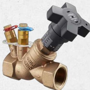
Für den hydraulischen Abgleich von Verteilungen in Zentralheizungs- und Kühlanlagen mit geschlossenen Kreisläufen. Die integrierte Messblende ermöglicht einfaches Einmessen.
