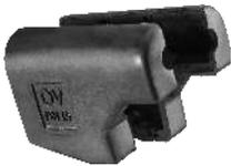
Aus PUR Hartschaum mit mehrfacher Clipsverbindung. Betriebstemperatur kurzzeitig bis 150 °C. Entspricht den Anforderungen gemäß Anlage 8 zu §§ 69 und 71 Absatz 1, Zeile ee) des Gebäudeenergiegesetzes (GEG). Baustoffklasse B2 nach DIN 4102.
