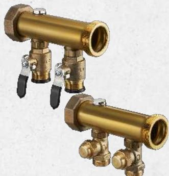
Die **Multidis SFI** Verteiler aus Messing für Industrieflächenheizung/-kühlung und Betonkernaktivierung für 2 - 6 Kreise sind im Vorlauf mit Kugelhähnen und im Rücklauf mit Regulierventilen ausgerüstet. Eine Erweiterung der Kreise auf bis zu 20 ist durch Verbinden der Verteilermodule möglich.
