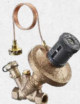
Für den automatischen hydraulischen Abgleich von Verteilleitungen in Zentralheizungs- und Kühlanlagen mit geschlossenen Kreisläufen. Die Differenzdruckregelung gewährleistet den hydraulischen Abgleich auch im Teillastbereich und verhindert hohe Differenzdrücke im regelten Anlagenabschnitt, z.B. am Heizkörperventil.
