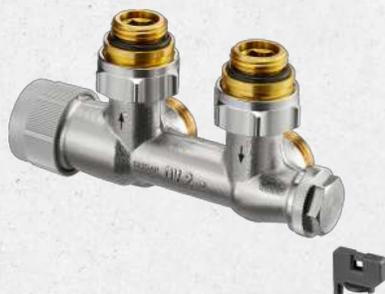
Die Multiblock TQ Anschlussarmatur ist eine Kombination aus Thermostatventil und Anschlussverschraubung am Heizkörper. Durch den speziellen QA-Ventileinsatz ist die Armatur für den automatischen hydraulischen Abgleich am Heizkörper in Zentralheizungs- und Kühlanlagen mit geschlossenen Kreisläufen geeignet. Die Armatur ist zum Heizkörper weichdichtend. Die Anschlussarmatur ist für den Anschluss an Heizkörper mit G 1/2 IG geeignet.
