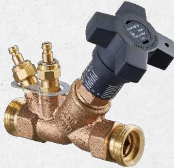
Speziell für den hydraulischen Abgleich von Kollektorfeldern in Solaranlagen mit geschlossenen Kreisläufen. Keine Absperrmöglichkeit um einen Mindestdurchfluss zu gewährleisten. Durchflussbestimmung durch Differenzdruckmessung über die integrierte, feste Messblende.
