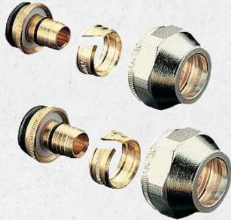
Cofit S Klemmringverschraubungen für G  $\frac{3}{4}$  AG sind universell einsetzbar für Mehrschichtverbundrohre sowie, bei gleicher Verarbeitung, für Kunststoffrohre (PE-Xc-Rohre und PE-RT-Rohre). Sie sind durch einen O-Ring weichdichtend und durch zusätzlicher Ab-
