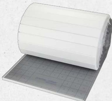
Das **Cofloor System Tackern** besteht aus einer Dämmrolle bzw. einer Faltplatte, Rohr und Tackernadeln. Dieses System kann für den Neubau und für die Renovierung eingesetzt werden. Die Dämmrolle und die Faltplatte aus EPS (Expandiertes Polystyrol) sind mit einer aufkaschierten Gewebefolie versehen und haben ein aufgedrucktes Verlegeraster (Rasterabstand 5 cm).
