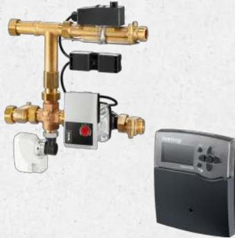
Die **Regufloor** Regelstationen werden zur Vorlauftemperaturregelung für Flächenheizungen und -kühlungen (**Regufloor HC**) eingesetzt. So kann die maximal/minimal zulässige Vorlauf-temperatur für Flächenheizungen und -kühlungen eingehalten werden. Die Regelung der Vorlauftemperatur erfolgt dabei entweder über eine elektronische Regelung in Verbindung mit einem Stellantrieb (z.B. witterungs-
