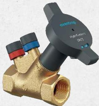
Für den hydraulischen Abgleich von Verteilungen in Zentralheizungs- und Kühlanlagen mit geschlossenen Kreisläufen. Durchflussbestimmung durch Differenzdruckmessung mit dem Messsystem OV-DMC 3 unter Berücksichtigung der Voreinstellwerte. In Schrägsitzausführung mit gesicherter, jederzeit kontrollierbarer, stufenloser Feinstvoreinstellung. Alle Funktionselemente auf der
