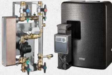
Die Regumaq X-80 Frischwasserstation ist eine elektronisch geregelte Armaturengruppe mit Wärmeübertrager zur hygienischen Trinkwassererwärmung nach dem Durchlaufprinzip zum Anschluss an einen Pufferspeicher. Abhängig von der Temperatur und dem Volumenstrom auf der Trinkwasserseite wird die Umwälzpumpe auf der Heizungsseite drehzahl geregelt. Bei der Auswahl der Frischwasserstation ist es notwendig die Wasserqualität des Einsatzgebietes zu beachten.
