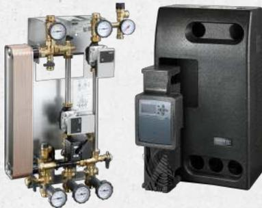
Die Regusol X Stationen mit Wärmeübertrager ermöglichen eine kontrollierte Übertragung der Wärmeenergie von einem Solarkreis (Primärkreis) an einen Speicherkreis (Sekundärkreis). Die Stationen ermöglichen das vor- und rücklaufseitige Absperren des Solarkreislaufs und verhindern über integrierte Sperrventile eine Eigenzirkulation bei abgeschalteter Pumpe. Der integrierte elektronische Regler übernimmt die Steuerung und Überwachung der solarthermischen Anlage.
