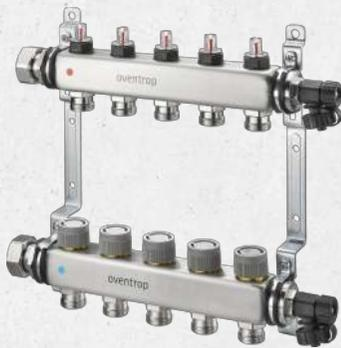
Die **Multidis SFQ** Heizkreisverteiler aus Edelstahl für Flächenheizung und -kühlung für 2 – 12 Heizkreise sind im Vorlauf mit integrierten Durchflussindikatoren bzw. mit integrierten Absperrungen ausgerüstet. Im Rücklauf sind QM Ventileinsätze mit einem Anschlussgewinde M 30 x 1,5 integriert, um optional Stellantriebe anzuschließen. Durch den speziellen QM Ventileinsatz ist die Armatur für den automatischen hydraulischen Abgleich in Zentralheizungs- und Kühlanlagen mit geschlosse-
