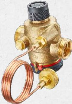
Differenzdruckregler mit Durchflussbegrenzung und Zonenregelung für den Einbau in Zentralheizungs- und Kühlanlagen. Die Ventilkombination kann mit einem Stellantrieb oder einem Handregulierkopf ausgestattet werden. Zusätzlich wird der maximale Differenzdruck über die Regelzone beschränkt. Ventil in Zweibegeausführung, mit gesicherter, plombierbarer, stufenloser Durchflussbe-
