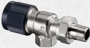
Rücklauftemperaturbegrenzer werden in kombinierten Radiator- und Flächenheizungsanlagen mit geschlossenen Kreisläufen eingesetzt. Die Ventile sind in der Ausführung Rücklauf-Axial und Rücklauf-Durchgang verfügbar. Der integrierte Ventileinsatz hat einen Doppelkegel verbaut, der unbeabsichtigtes Überhitzen
