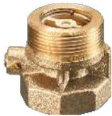
Zur Verhinderung einer Schwerkraftzirkulation in verschiedenen Heizungssystemen bei abgeschalteter Pumpe. Zum Einbau nach der Pumpe. Öffnungsdruck 20 mbar.
