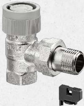
Für den automatischen hydraulischen Abgleich am Heizkörper in Zentralheizungs- und Kühlanlagen mit geschlossenen Kreisläufen. Einbau im Vorlauf. Die Q-Tech Ventile eignen sich ideal zur Nachrüstung und Sanierung von bestehenden Heizungsanlagen, da aufwendige Berechnungen von Voreinstellwerten nicht erforderlich sind. Der Volumenstrom wird auch bei schwankendem Differenzdruck in der Anlage konstant gehalten. Der Durchflussbereich
