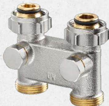
Umlenkstücke sind Anschlussarmaturen, welche für vertauschten Vor- und Rücklauf an Heizkörpern mit integrierter Ventilgarnitur konzipiert sind. Sie sorgen dafür, dass der Ventileinsatz wieder korrekt angeströmt wird indem sie Vor- und Rücklauf über Kreuz tauschen.
