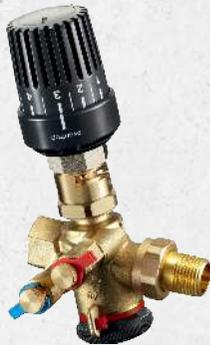
Das Unofix-System zur Sanierung von Einrohrheizungsanlagen basiert auf dem differenzdruckunabhängigen Regelventil Cocon QTZ. Es ist in verschiedenen Varianten verfügbar: Als Basisvariante Unofix QB mit reiner Volumenstrombegrenzung oder als Unofix QT mit zusätzlichem Stellantrieb und Raumthermostaten mit Zeitintervall zur z.B. Nachtabsen-
