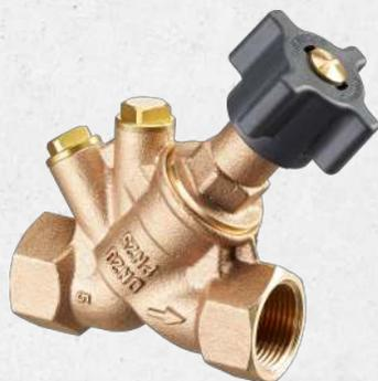
Für die Absperrung von Verteilungen in Zentralheizungs- und Kühlanlagen mit geschlossenen Kreisläufen. Ventil in Schrägsitzausführung ohne Voreinstellung. Mit Blindstopfen verschlossene Messanschlüsse. Diffusionsdichte Wärmedämmschalen bis 120 °C als Zubehör für Nennweiten bis DN 50 erhältlich. Ventilgehäuse und medienberührende Teile aus Rotguss, Grauguss, entzinkungsbeständigem Messing, Edelstahl oder PTFE. Wartungsfreie Spindelabdichtung.
