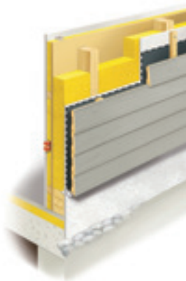
Wandaufbau der Holzskelettbauweise.
