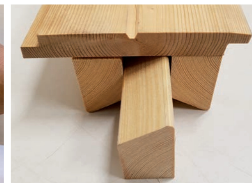
4. Die Deckbreite der Wechselfalzprofile entspricht genau viermal der Stärke eines Parallelogramms. So können Sie die Parallelogramme als Abstandhalter nutzen.
