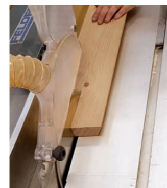
2. Pro Parallelogramm ist ein Längsschnitt positionsgenau zu setzen.
