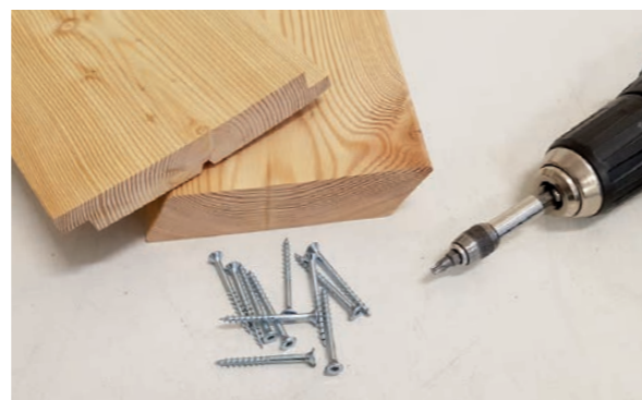
1. Für die fachgerechte Vormontage verwenden Sie bitte Edelstahlschrauben 5 x 60 mm (Teilgewinde) mit Bohrsch Spitze und Fräsrillen.
