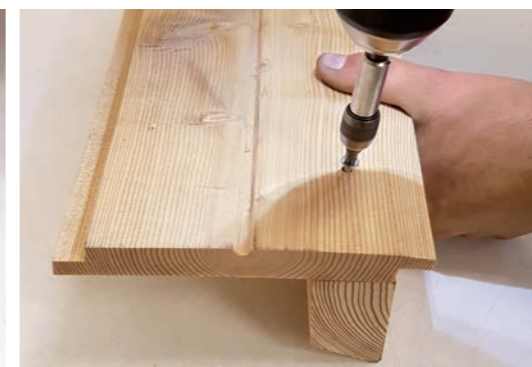
3. Schrauben Sie die aufgetrennten Parallelogramme von hinten auf die Wechselfalzprofile.
