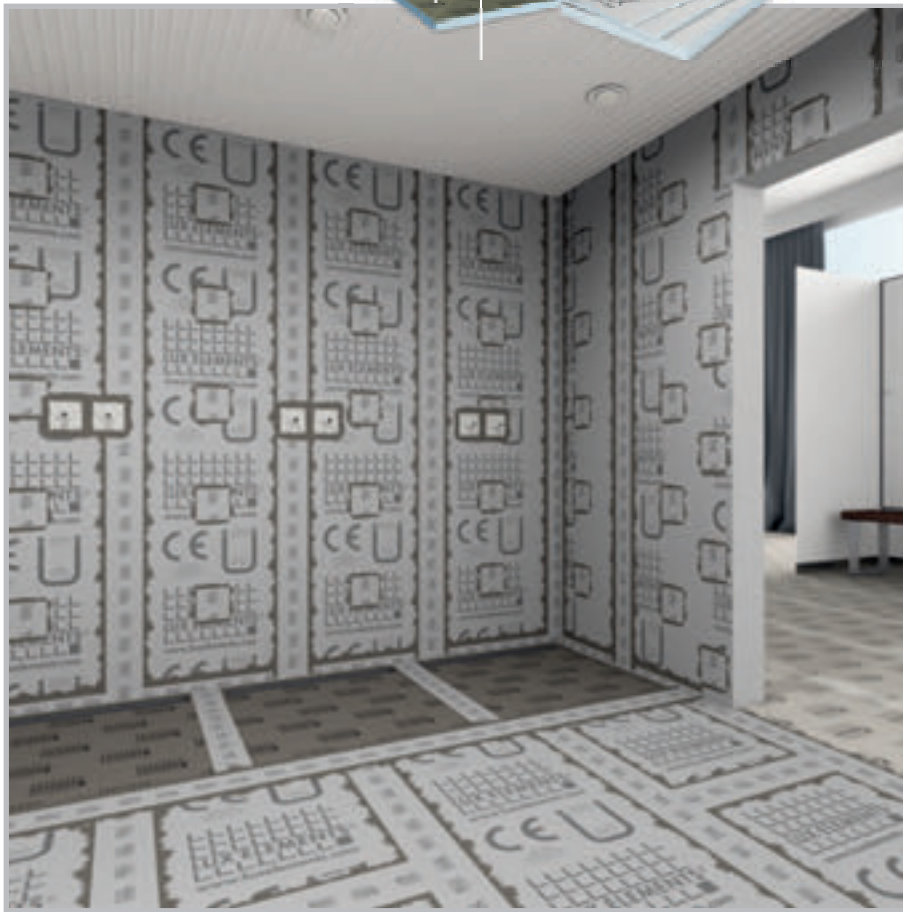
Duschbereich mit plattenförmiger Abdichtung
