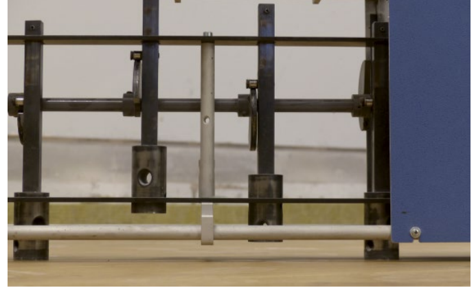
Abb. GS. 5: Bauakustischer Prüfstand zur Messung der Trittschalldämmung [Knauf Gips KG]
