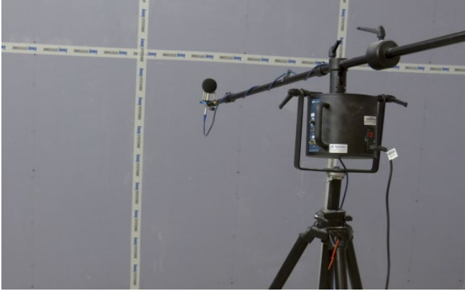
Abb. GS. 4: Bauakustischer Prüfstand zur Messung der Luftschalldämmung [Knauf Gips KG]
