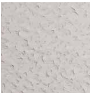
AluPlusPatina Natur-Aluminium, stucco-dessiniert – Standard für Kalzip Profiltafeln
