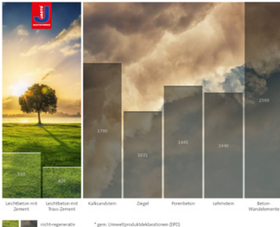
PRIMÄRENERGIEBEDARF (ENERGIE, DIE BEI DER HERSTELLUNG AUFGEWENDET WERDEN MUSS) IN MJ PRO KUBIKMETER WANDBAUSTOFF*
