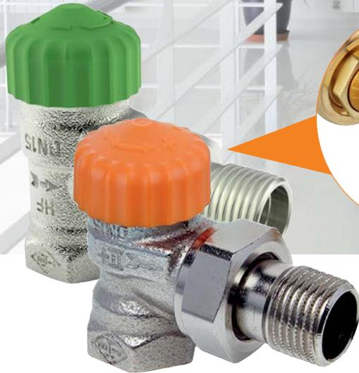
**Eclipse ist das kleinste Thermostat-Ventilunterteil mit automatischer Durchflussregelung und ist in allen Standard-Ventilgrößen und Baumformen erhältlich. Das Ventil regelt den Durchfluss unabhängig vom Differenzdruck auf den voreingestellten Wert. Dabei sind Durchflussbereiche von 10–150 bzw. 30 - 300 l/h möglich.**
