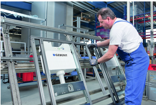
Abbildung 29: Montage der Sanitäreinheiten im Werk
