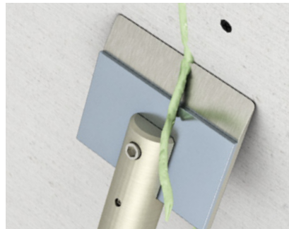
Den ausgehärteten Kleber abstoßen.
