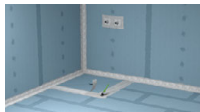
In den Anschlussbereichen analog abdichten und anschließend vollflächig auf das Duschelement auftragen (ggf. auch restliche Bodenfläche).
