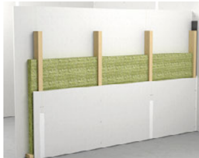
Anschließend Installationen einbauen und bei Bedarf das Gefach ausdämmen.
