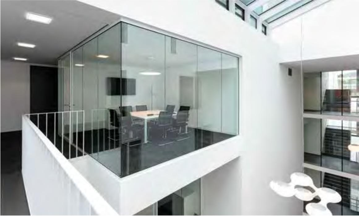
Der Zusammenschluss zweier Geldinstitute initiierte den Neubau der VR-Bank Ostalb in der Aalener Innenstadt. Zwei Baukörper, die einen Platz als angemessenes Entree bilden, werden mit einer gläsernen viergeschossigen Halle verbunden. Die Nurglaskonstruktion fecoplan als absturzsichernde Verglasung ermöglicht spannende Sichtbeziehungen und mit einem Schalldämmprüfwert von  $R_{w,P} = 42$  dB auch ein hohes Maß an Vertraulichkeit.
