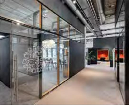
Die bodengeführte Glas-Schiebetür fungiert als Schallschirm.
