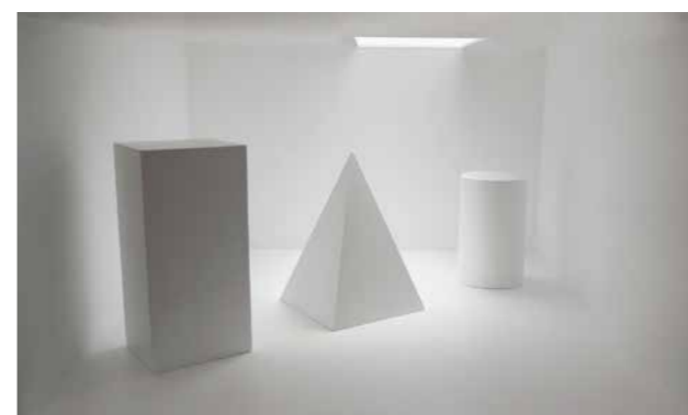
Ein Oberlicht mit opaler Schale erzeugt ein Streulicht, das räumliche Strukturen besser erkennbar macht.
