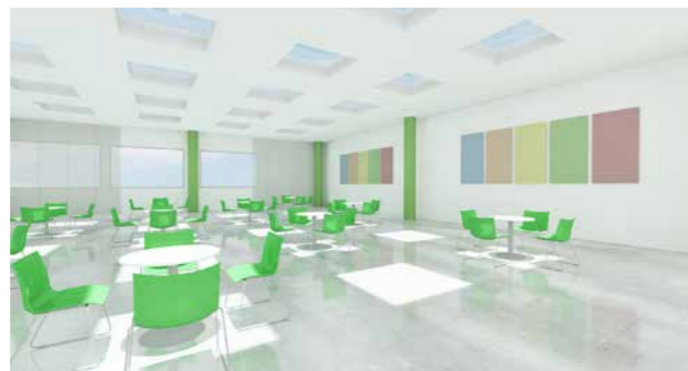
Erhöht sich die Anzahl der Oberlichter, wird der Effekt der punktuellen Belichtung verstärkt. Hier bildet die Form der Oberlichter einen Kontrast zur Möblierung.
