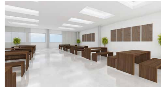
Wenige große Oberlichter mit opaler Verglasung erzeugen eine gleichmäßigere Belichtung.
