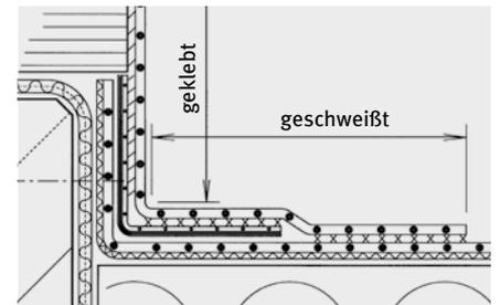
VSKA-Anschlussbahnen werden mit einem beidseitigen oder einseitigen, unbeschichteten Schweißrand hergestellt. Auf diese Weise ist die materialhomogene Verschweißung der VSKA-Anschlussbahnen mit der EVALON®-Abdichtung sichergestellt.
